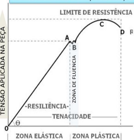
GRÁFICO TENSÃO APLICADA À PEÇA x DEFORMAÇÃO
